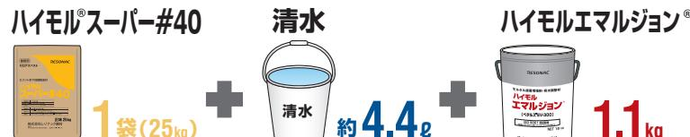
所定量のハイモルエマルジョン(1.1kg)と清水(約4.4ℓ)を容器に入れ、次にハンドミキサー等で攪拌しながらスーパー#40(1袋)を徐々に加え、十分に練り混ぜ(約3分)、施工軟度に調整してください。(可使時間は約60分です)。練り足し、水を加えての練り戻しは避けてください。
