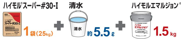
所定量のハイモルエマルジョン(1.5kg)と清水(約5.5L)を容器に入れ、次にハンドミキサー等で攪拌しながらスーパー#30-I(1袋)を徐々に加え、十分に練り混ぜ(約3分)、施工軟度に調整してください。(可使時間は約1時間です)。
