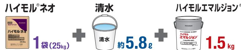
所定量のハイモルエマルジョン(1.5kg)と清水(約5.8ℓ)を容器に入れ、次にハンドミキサー等で攪拌しながらハイモルネオ(1袋)を徐々に加え、十分に練り混ぜ(約3分)、施工軟度に調整してください。(可使時間は約60分です)。
