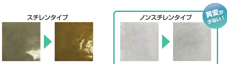
屋外暴露試験。7か月後のシート色の变化
